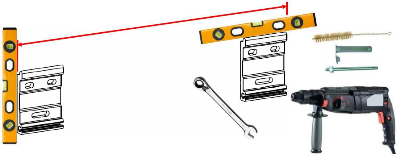
**Accrocher la partie des supports du coffre sur les platines préalablement fixées au mur.**
