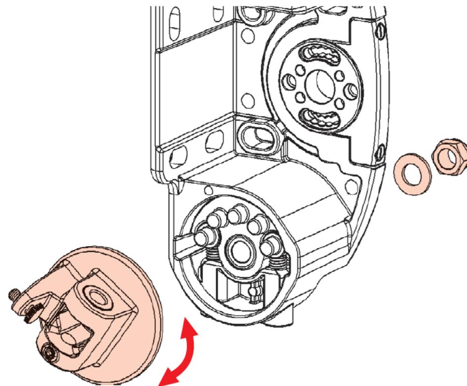
3 – Placer le bras sur la rotule, centrer l'axe dans le trou et fixer l'ensemble avec la vis hexagonale à tête creuse.
