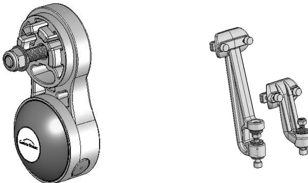
Installer le support de bras allongé sur la platine de fixation GAUCHE. (Le support droit est à installer en suivant la procédure du bras standard).
