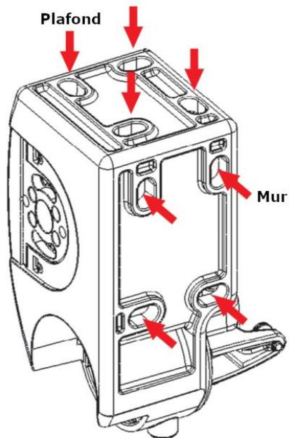
1 – Placer le support à l'endroit souhaité sur le mur ou le plafond (en position latérale « entre-murs », ouvrir les trous pour pouvoir visser).
